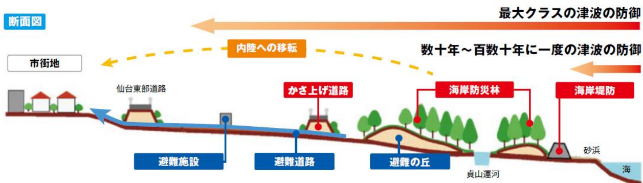
図 2-14 多重防御による総合的な津波対策
