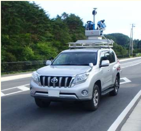
三次元測量機器(MMS)
