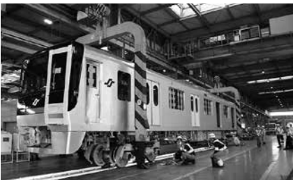
▲搬入された車両の調整や、車体と車輪を結合させる作業などが行われます。
