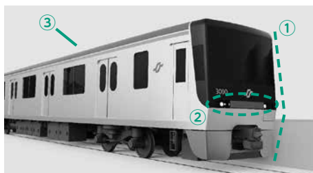
▲①車頭は「く」の字の形で、現行車両を継承②ライトはグリーンの前面ラインと一体化させ、現行車両から進化したイメージを創出③側面上部はグリーンのためのラインを2本施しました
