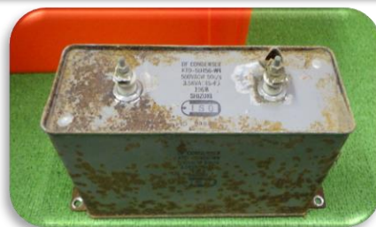
溶接機内のコンデンサー
