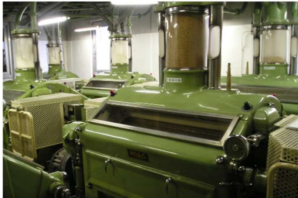
ロール機への原料投入
