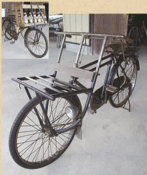
昭和20年代に製造された仙台式運搬車(古農具・民具資料館蔵) 積荷の重量に耐えるため、前輪のタイヤの太さは幅5〜7cmある
