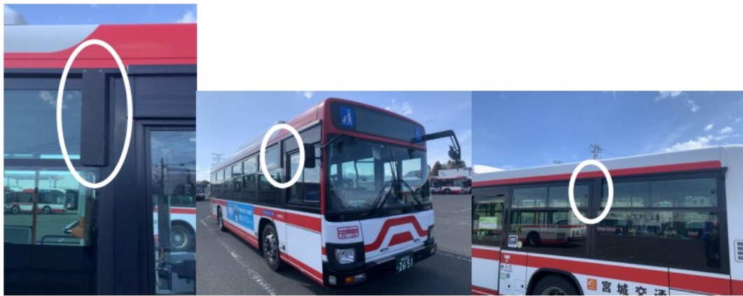
図 2-8 換気用ウインドバイザーの導入（宮城交通）
