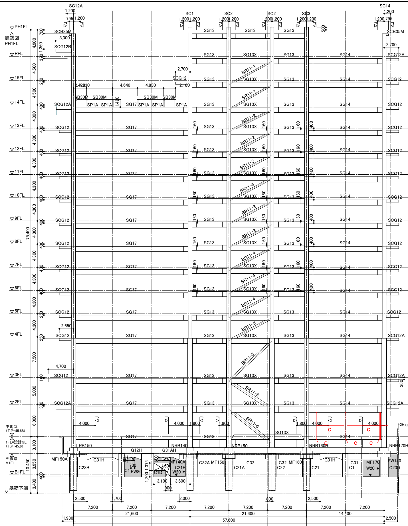
X4通り軸組図 1:200 特記なき限り 1. 梁JOINTは柱芯から1,200とする。1,200を基準としてJOINT位置をブレース・小梁と干渉する場合は現場溶接もしくは監理者との協議の上、移動可能とする。 2. Y4-Y7 PHFL 上部はヘリポート詳細図参照 3. 柱のJoint位置鉄骨柱リスト(S-314、315)による。
