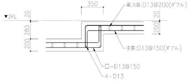
\*スラブ上端主筋はL3、下端主筋はL2で定着を取ること。
