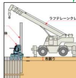
夜間工事での施工になります。今市福田線を通行止めにして作業を行います。現状の道路を使用したまま、工事が進めていけるようにするため矢板を施工します。
