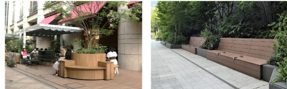
植栽の成長により座ることが困難とならないよう、背もたれにより植栽と縁が切られたベンチ
