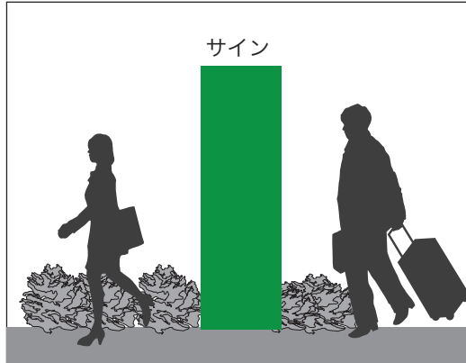
人通りの多いところでは、植栽帯の中などに設置する。
