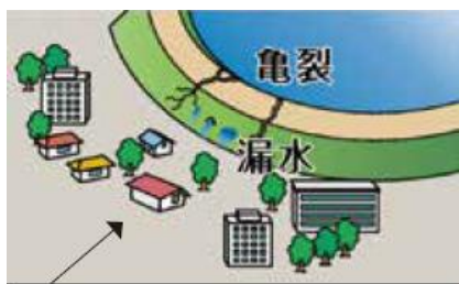
【決壊の前兆現象の例】 法面の崩れや堤の亀裂、水の噴出など
