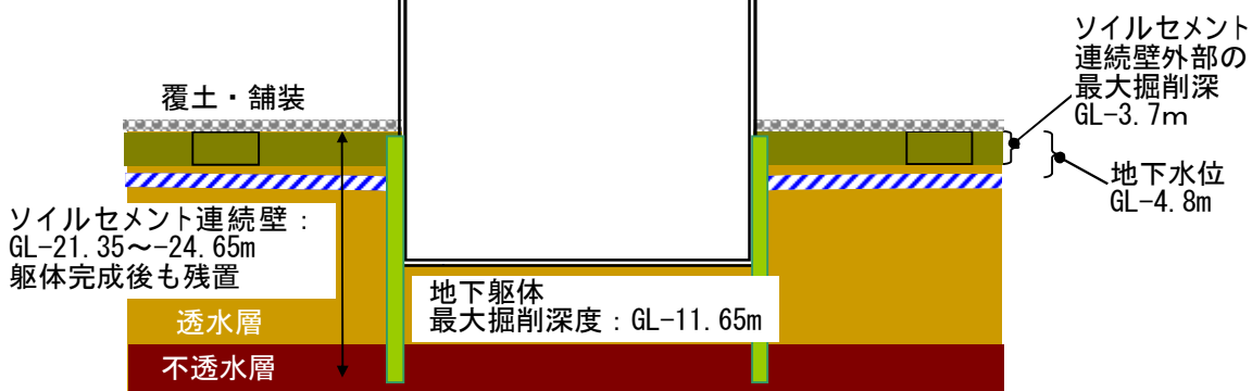
図 6.1-4 土壤汚染対策工事の概要
