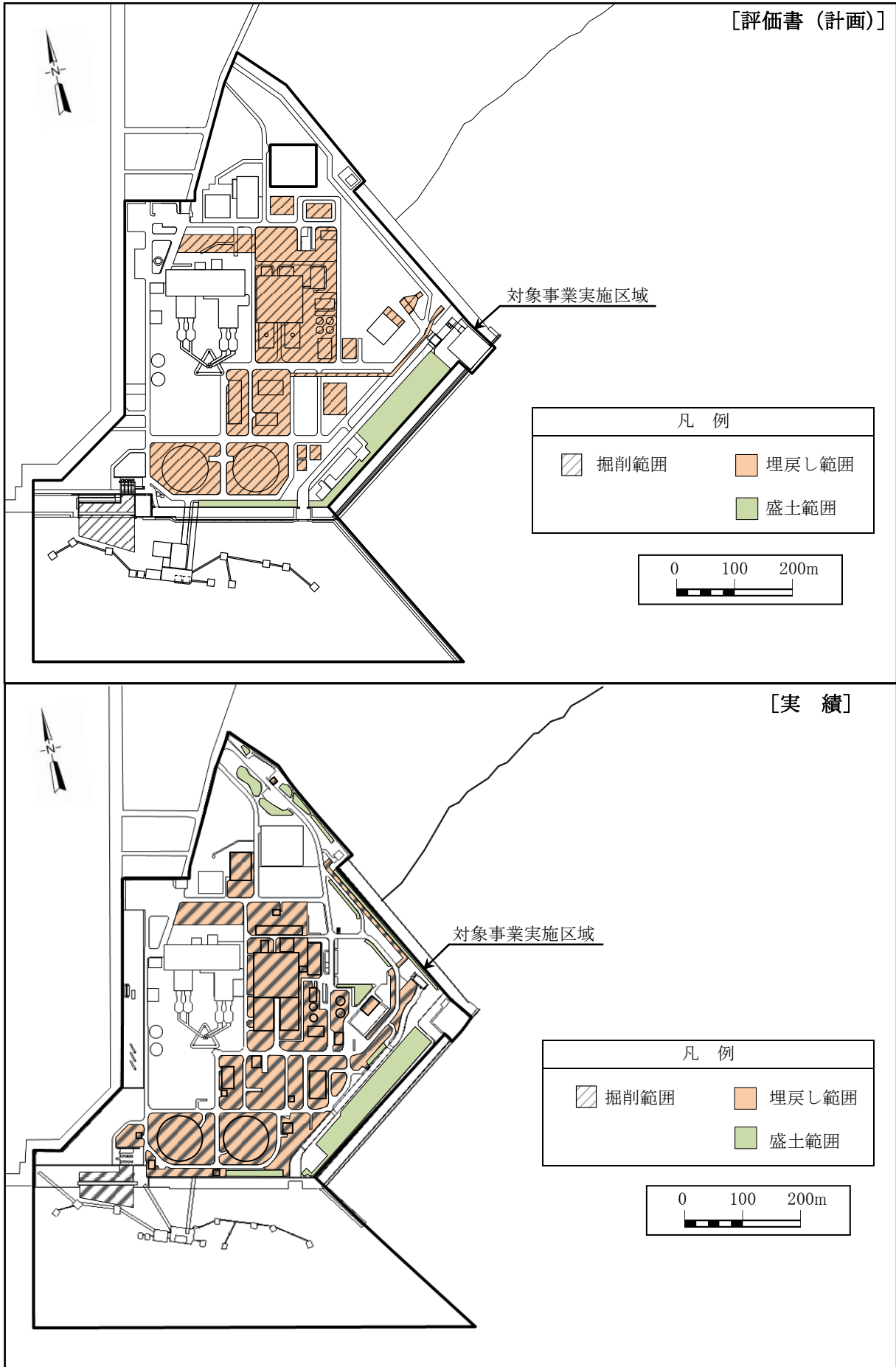
第 2.2-8 図 掘削及び埋戻し・盛土の範囲
