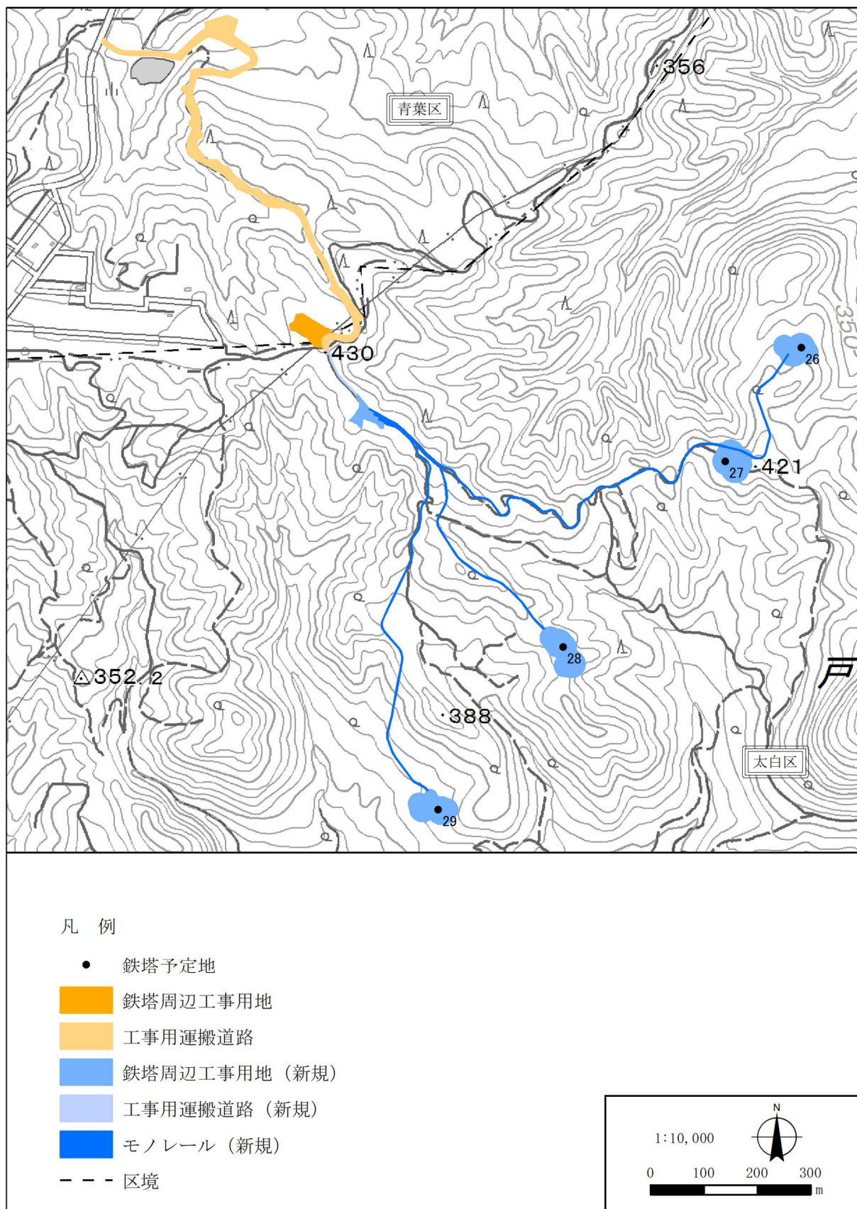
図 1.8-4 土地改変の範囲（鉄塔 No. 26～29：変更後）
