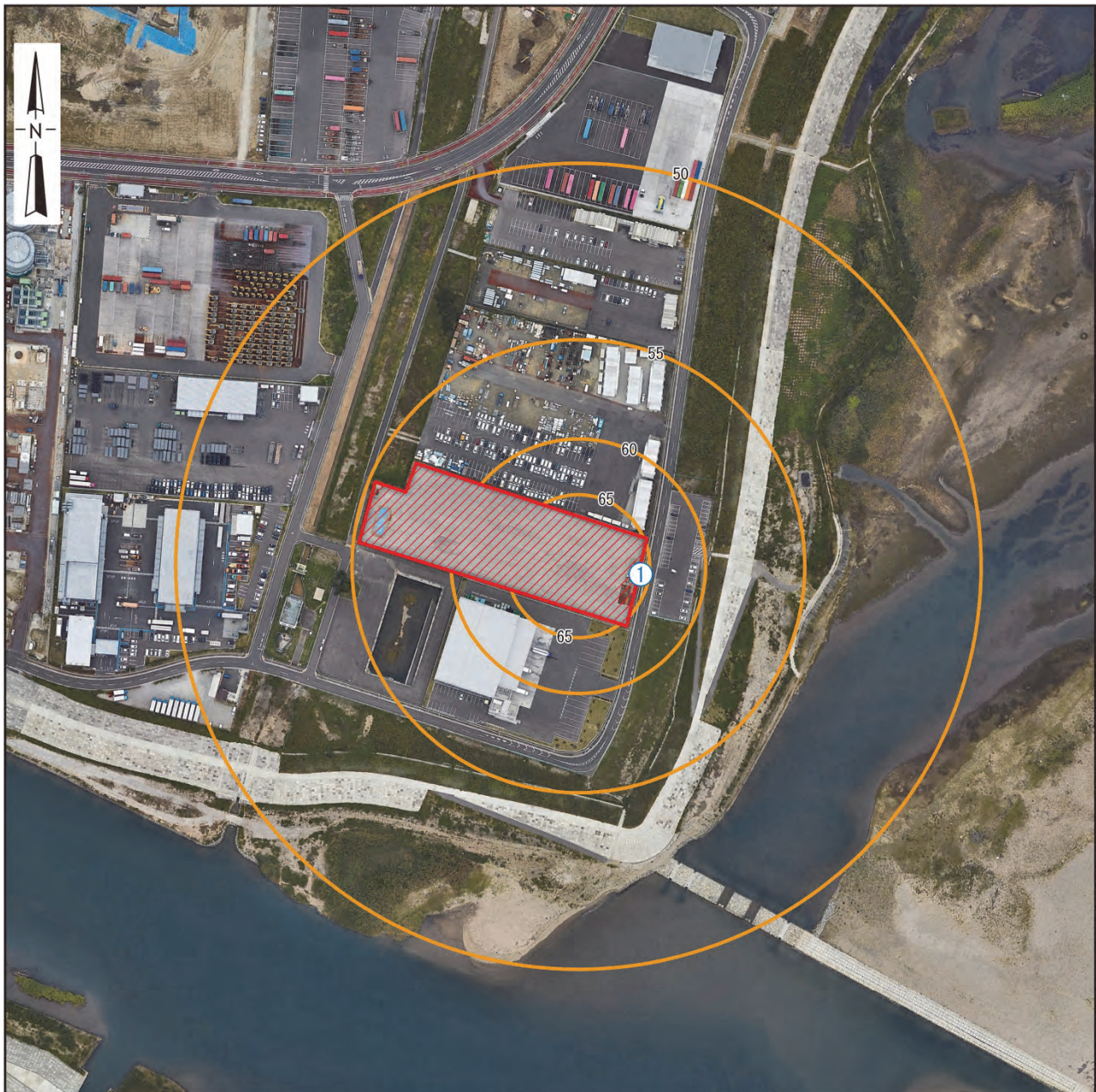
図 5.2-5(2) 騒音の補完予測結果（地上高 1.2m の寄与レベル： L_{Aeq} ）
