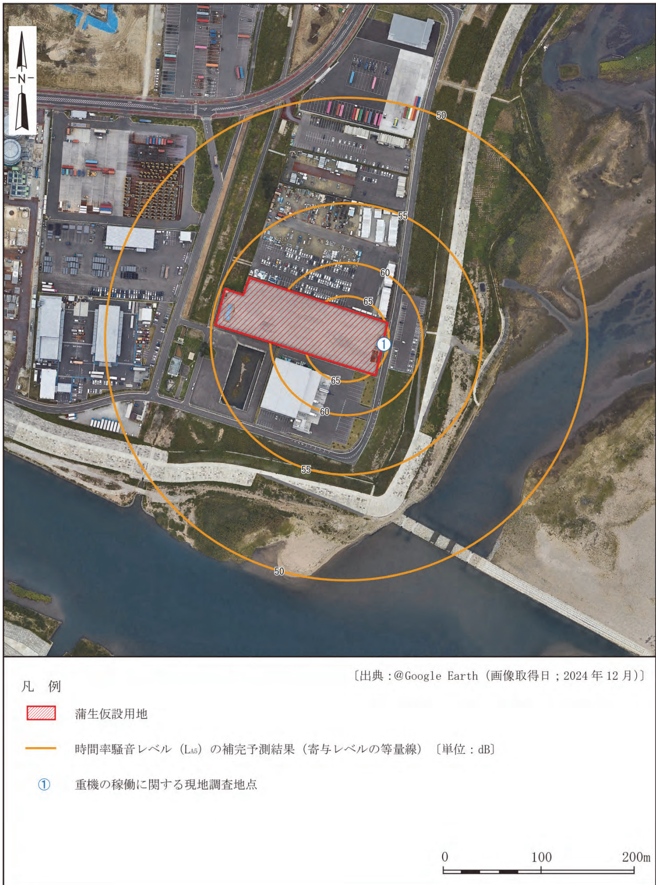
図 5.2-5(1) 騒音の補完予測結果（地上高 1.2mの寄与レベル： L_{A5} ）
