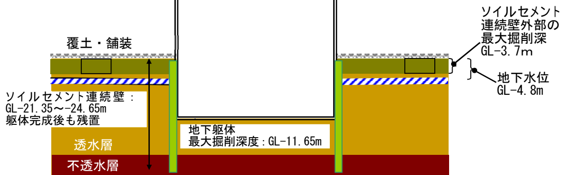
図 6.3-2 土壌汚染対策工事の概要
