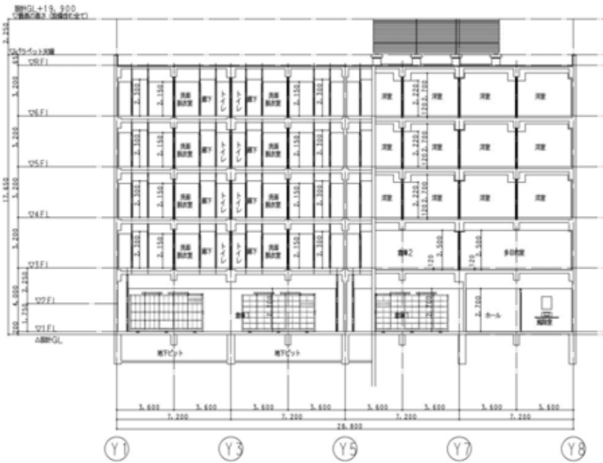
図 4.1-9-1(2) 研修医宿舎棟断面図(南側住戸)(評価書時)
