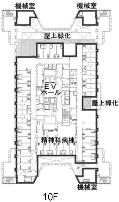
図 4.1-5-9(2) 病院本館建築平面図(10, 11階)(評価書時)
