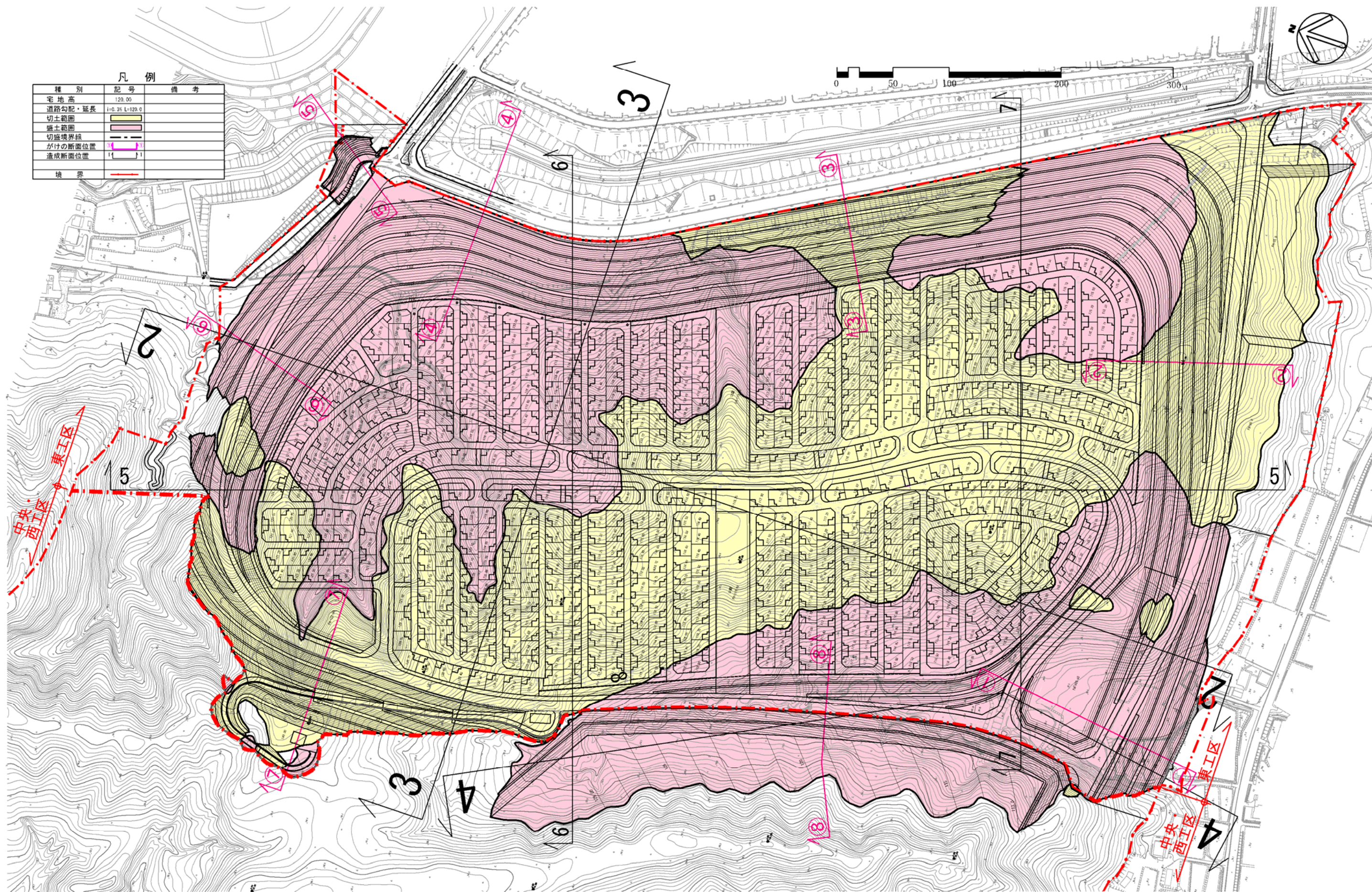
图 2.6-2 造成計画平面図（東工区分割施工）
