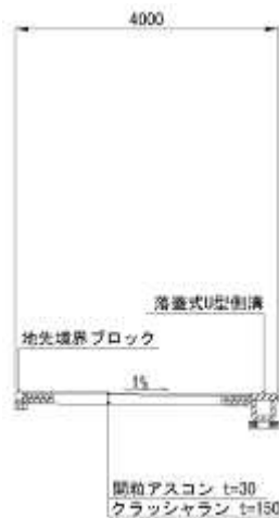
図 1.4-7(6) 道路標準断面図（自転車歩行者道）
