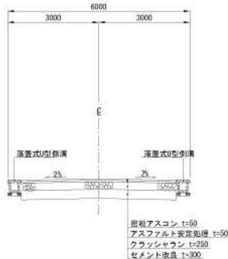
図 1.4-7(5) 道路標準断面図（区画道路）
