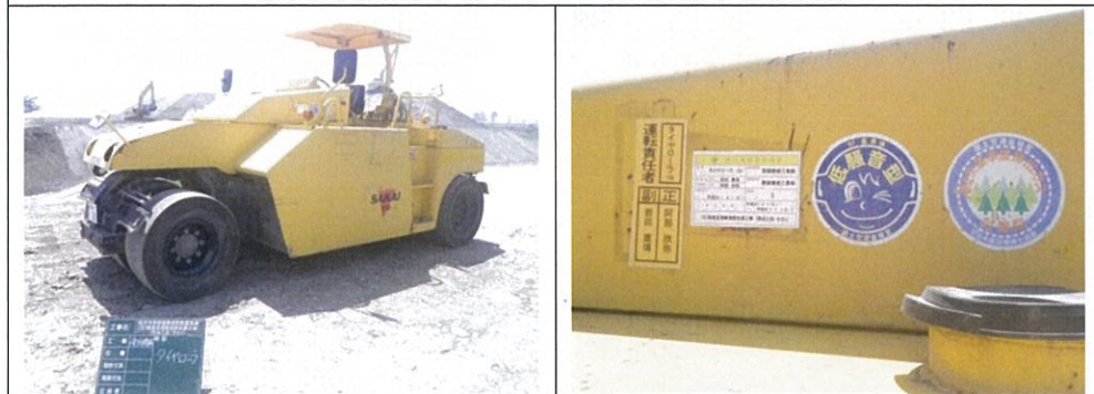
排出ガス対策型タイヤローラー (平成 26 年 9 月撮影)
