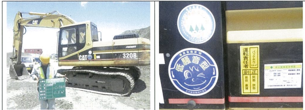
排出ガス対策型バックホウ (平成 26 年 9 月撮影)
