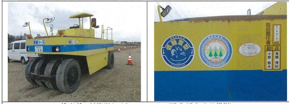
排出ガス対策型タイヤローラー (平成 27 年 2 月撮影)
