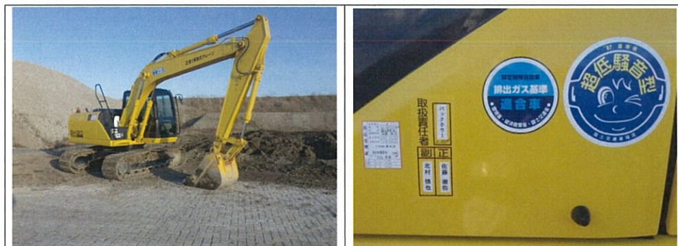
排出ガス対策型バックホウ (平成 27 年 2 月撮影) ※2020 燃費基準値より優れた燃費性能
