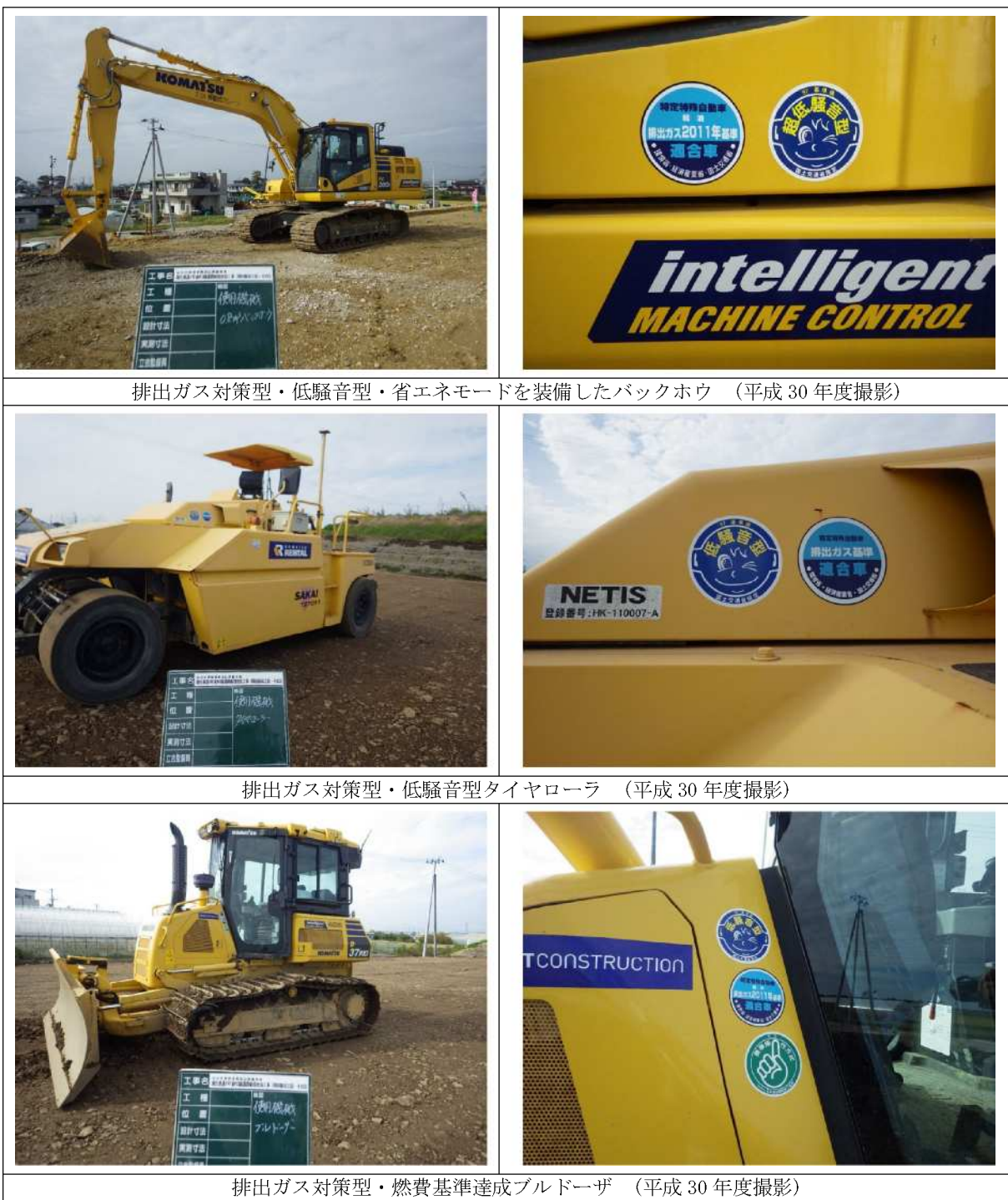
写真 8-22 排出ガス対策型・省エネモード装備・燃費基準達成建設機械の使用例
