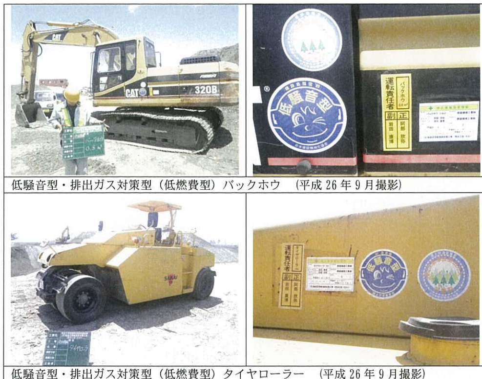
写真 6-2 排出ガス対策・騒音振動対策型機械の使用例
