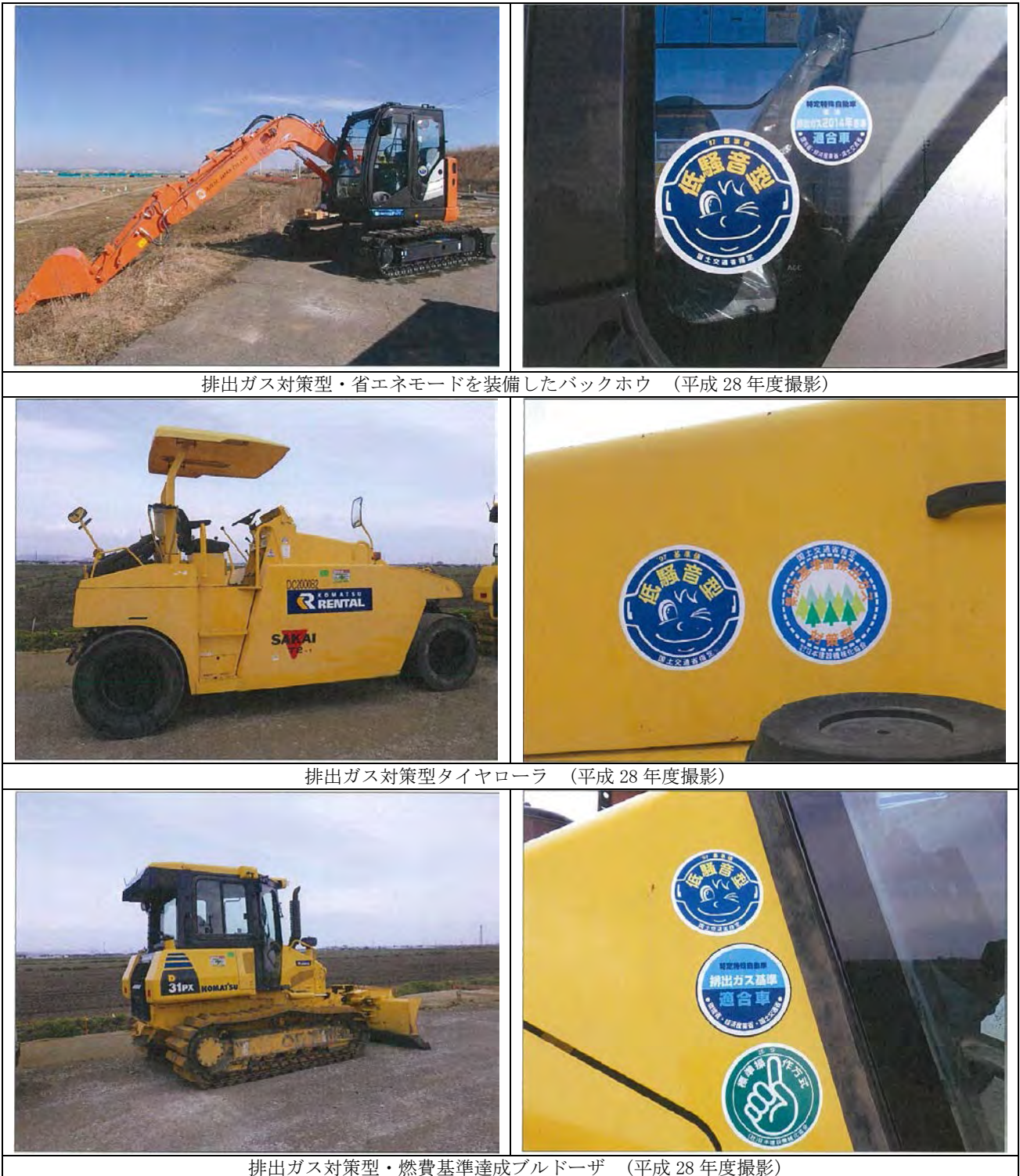
写真 8.11-1 排出ガス対策型・省エネモード装備・燃費基準達成建設機械の使用例
