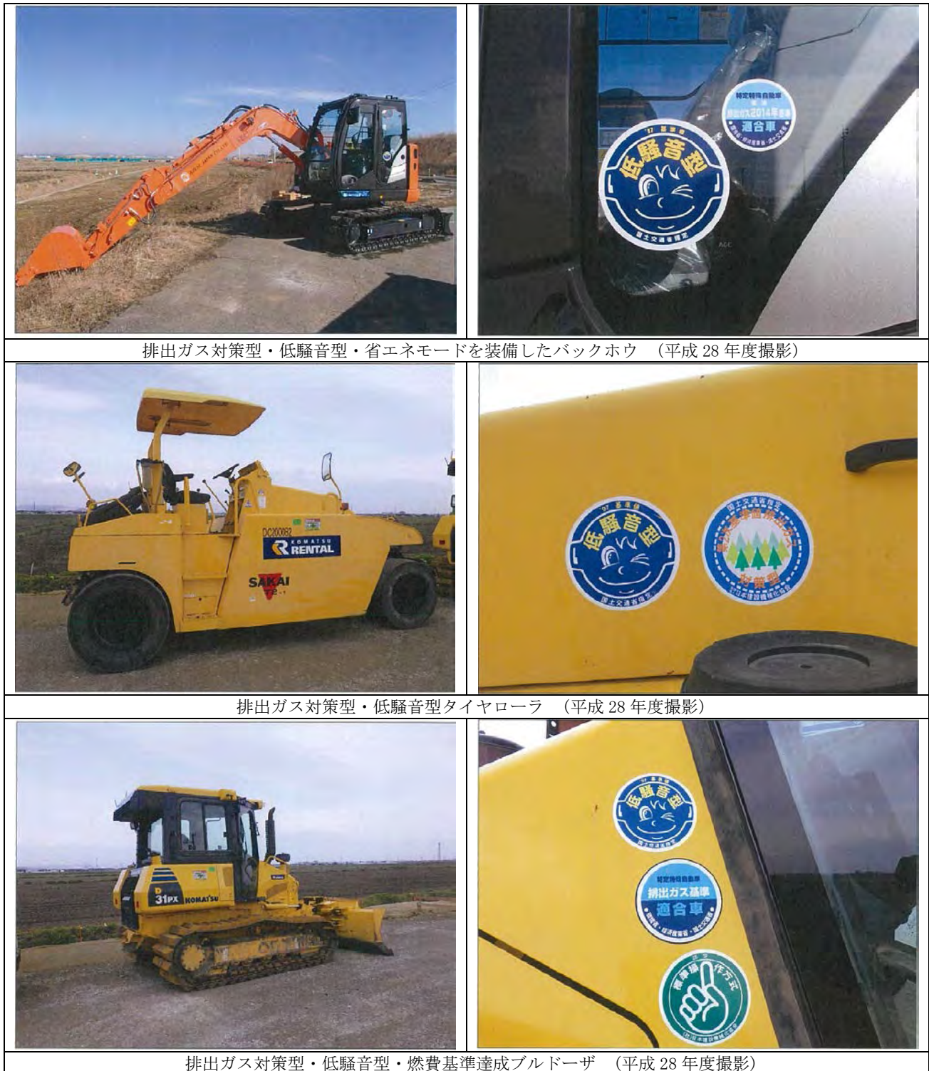
写真 6-1 排出ガス対策型・低騒音型・燃費基準達成建設機械の使用例
