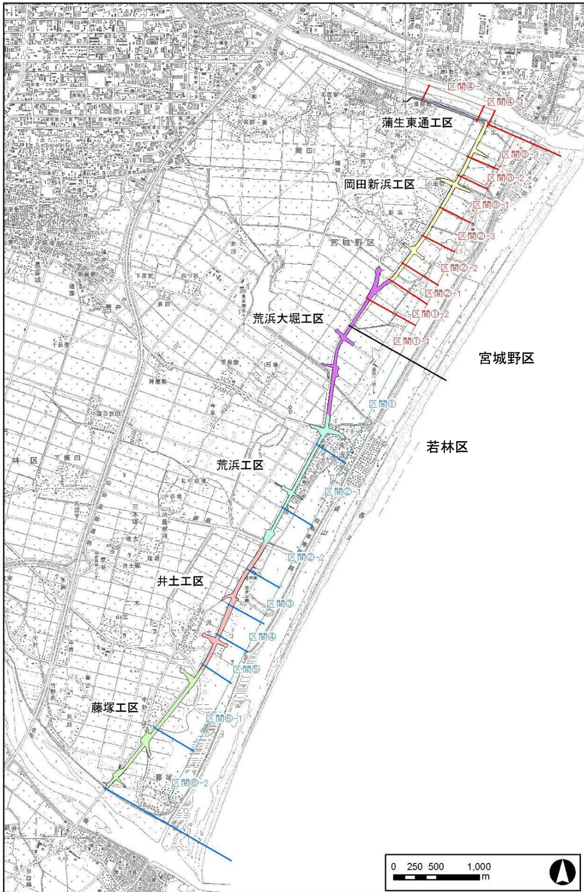
図 2.5-5 軟弱地盤対策工の区間区分
