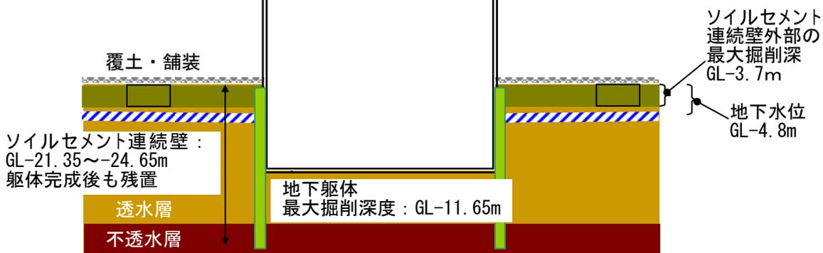
図 6.1-4 土壤汚染対策工事の概要
