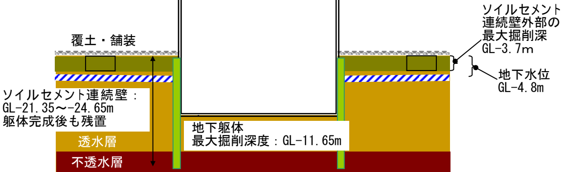
図 6.1-4 土壤汚染対策工事の概要
