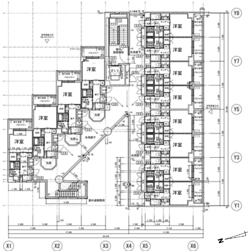
图 4.1-8-3(1) 研修医宿舍棟建築平面図(4,5階)(完成時)
