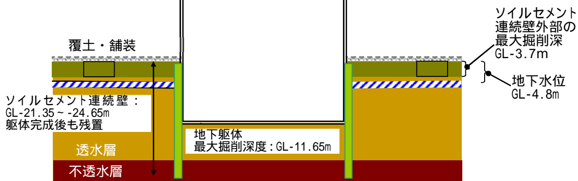
図 6.3-2 土壌汚染対策工事の概要
