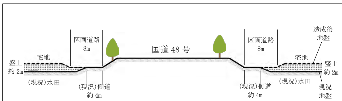
図1-5 国道48号沿道の造成断面イメージ
