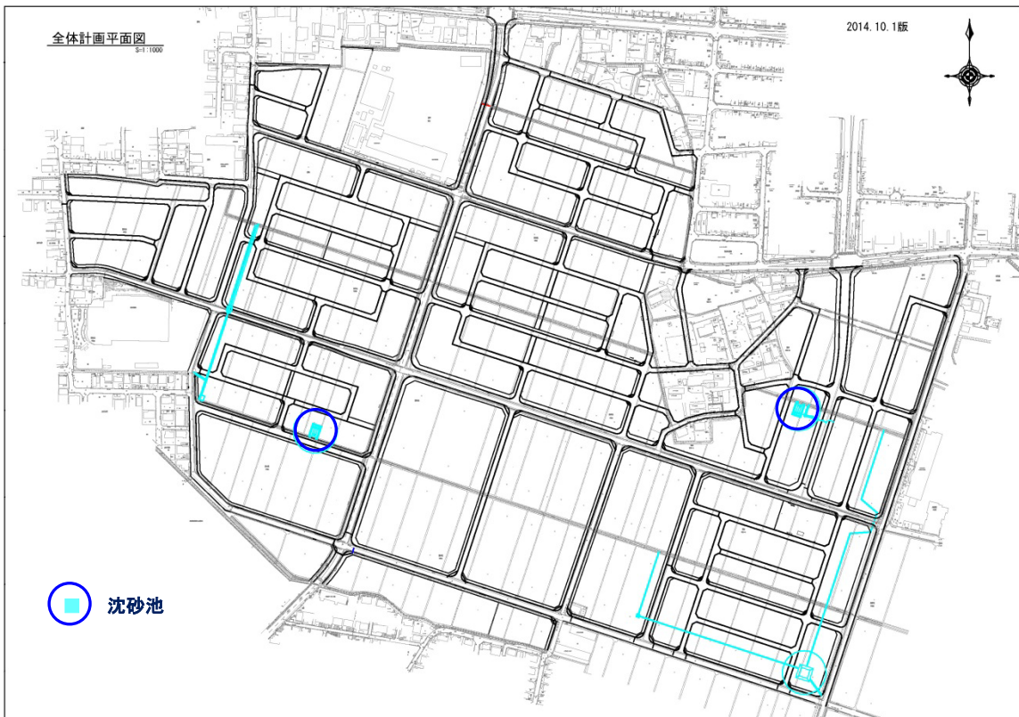
図 2.4-6(3) 仮設沈砂池位置図
