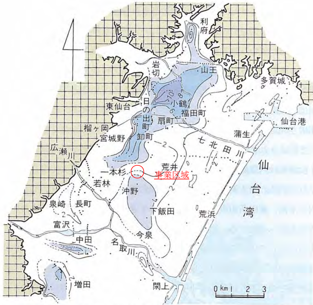
図 5.1-22 軟弱地盤の分布状況(図中数字は軟弱層の厚さ(m))
