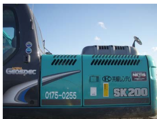
図 5-6 排出ガス適合・低騒音型建設機械 (平成 27 年 2 月 10 日)
