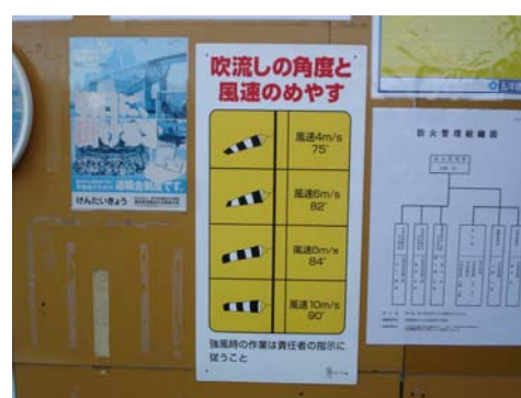
図 5-14 吹流しの角度と風速のめやす (掲示) (平成 26 年 1 月 29 日)
