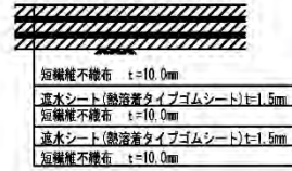
新設遮水シート断面図 (第5期)
