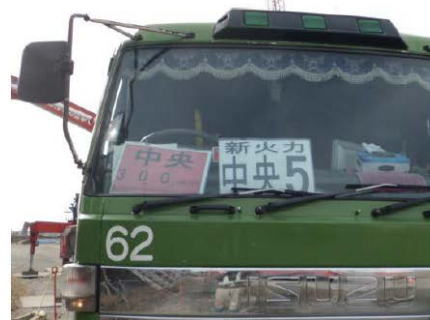
工事車両を示すプレートの掲示
