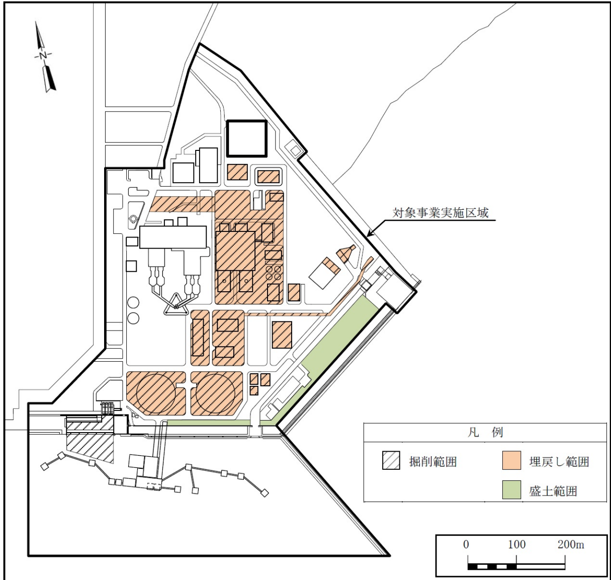
第 2.2-8 図 掘削及び埋戻し・盛土の範囲
