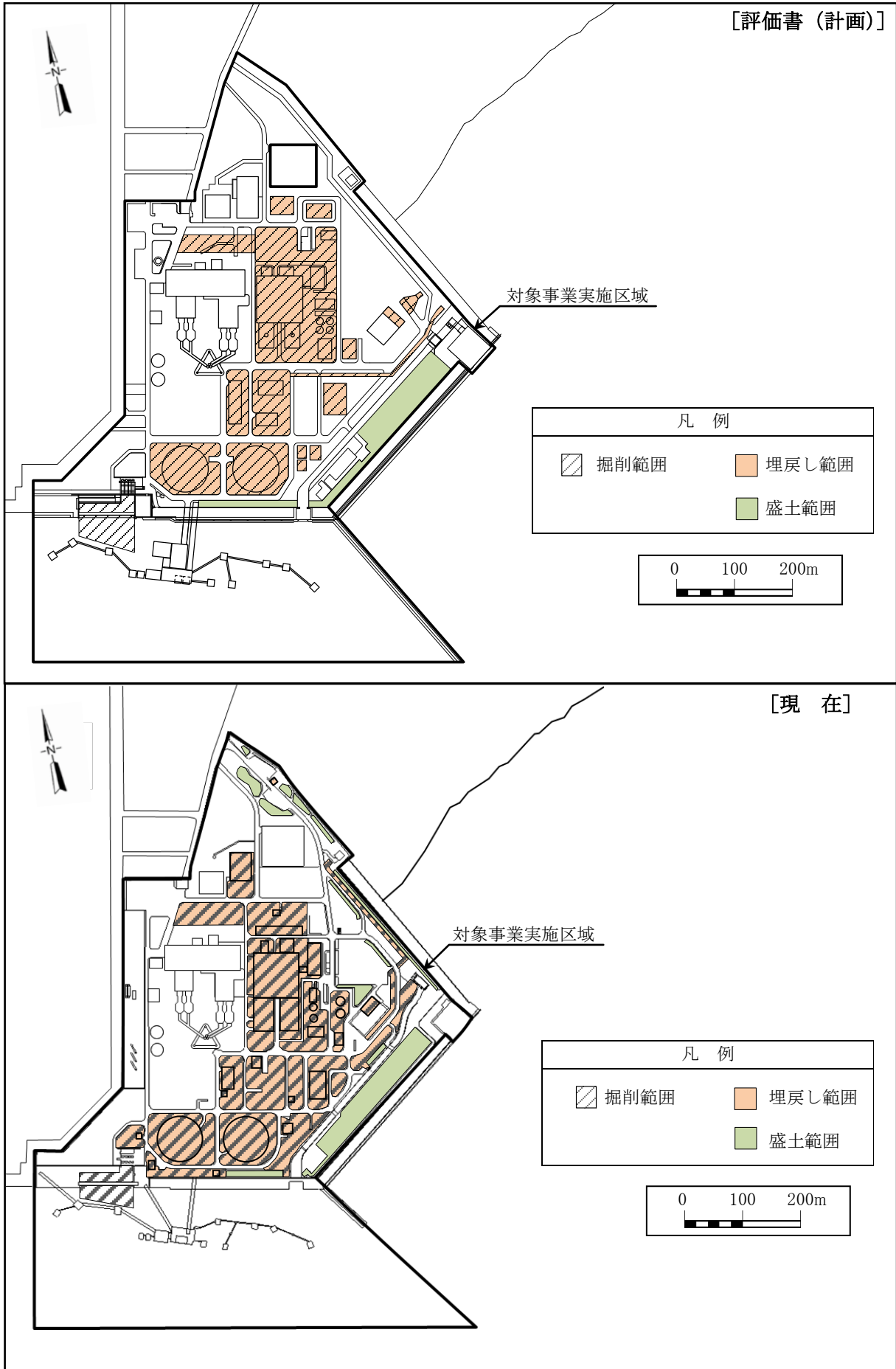
第 2.2-8 図 掘削及び埋戻し・盛土の範囲
