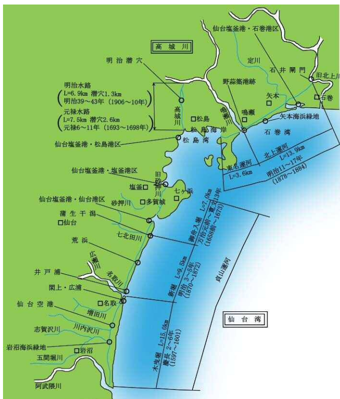
図 2-1-6 仙台湾沿岸地域における運河群位置図（貞山運河、東名運河、北上運河） （出典：第 2 回貞山運河再生・復興ビジョン検討座談会資料）
