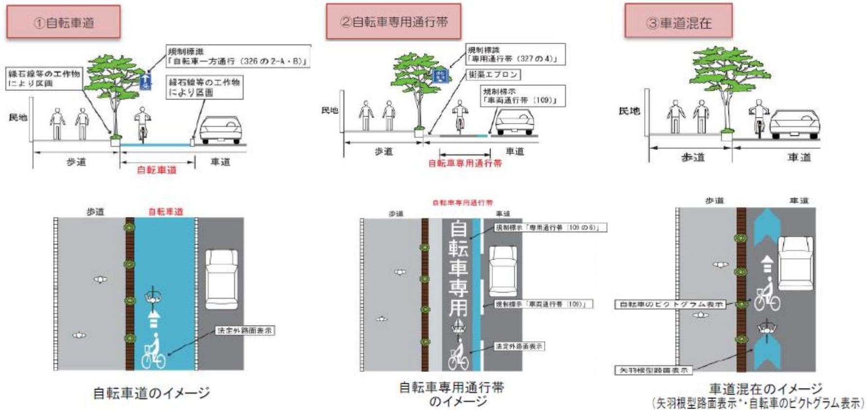
図14 整備形態の概要と具体的な法定外表示等の設置イメージ
