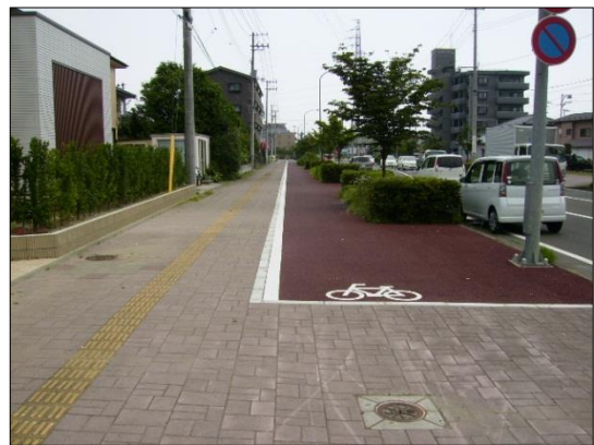
【写真 4-2】ベンガラ舗装による視覚分離の事例 (市道富沢山田線)
