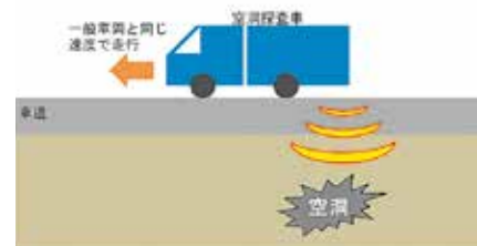
【路面下空洞調査の例】
