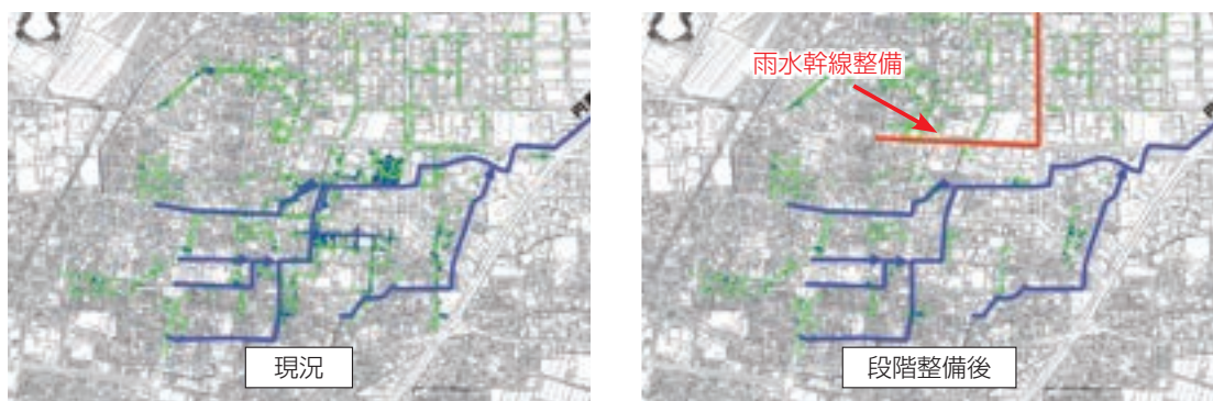
浸水シミュレーションを活用した効率的な雨水排水施設整備
