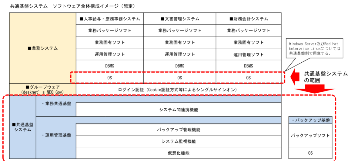
図表 4 共通基盤システムソフトウェア構成概要図
