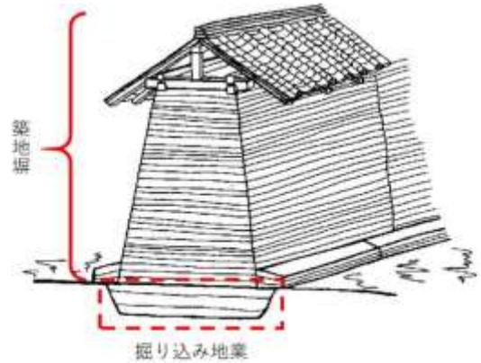
第8図 築地塀と掘り込み地業の断面模式
