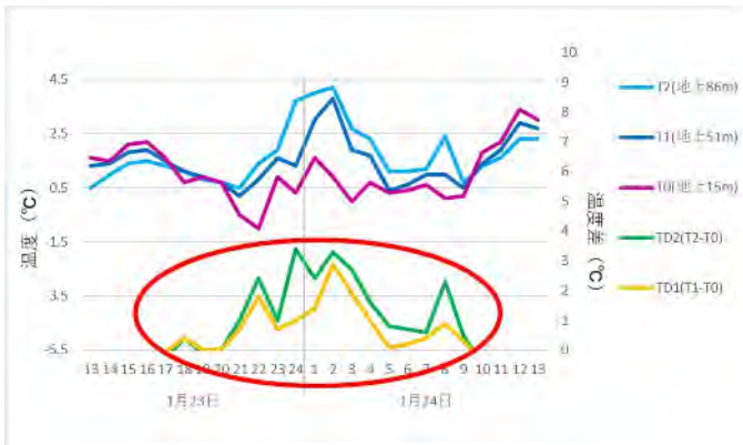
図 13 八木山測定局温度データ （○が逆転層が形成されていた時間）
